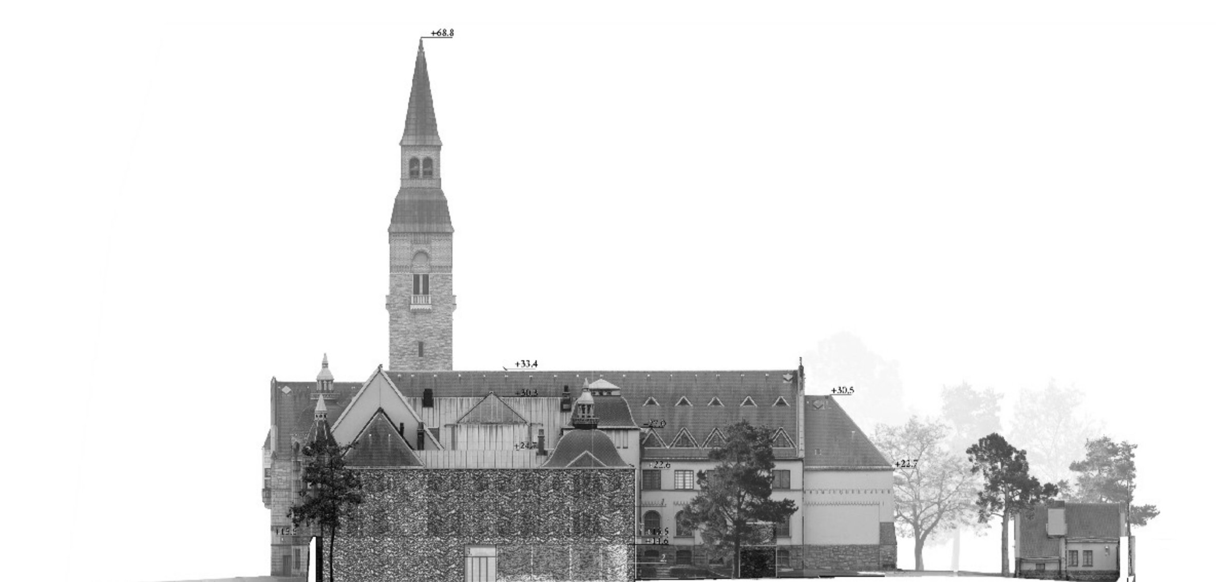
Julkisivun pohjoisosa, 1:400 Lisärakennuksen julkisivun materiaalit: 1. Perforoitu, kokokausittain messinkilevy 2. Perforoitu, kokokausittain messinkilevy, suurennettu aukotus 3. Lasit
